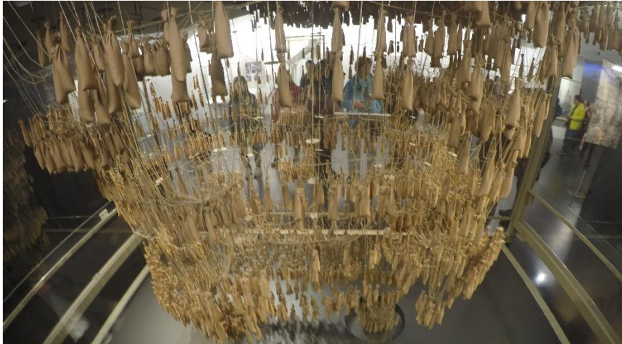
Fotoğraf 3. Sagrada Familia Asmalı Modeli (Hanging Model)
